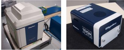
検出器としては自動読み取りイメージングプレート (R-AXIS IV++)、二次元半導体検出器 (Pilatus 100K)、X線II-CCD (C4742) およびフラットパネル検出器が利用可能となっている。IP、Pilatus、CCDはレール上の架台に据え付けられ、任意に位置に検出器を設置することができる。また横方向の移動で検出器の入れ替えが可能となっている。
