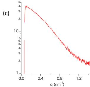
BL8S3を利用して標準的な試料の散乱を測定した。(a) シリカ粉末の分散溶液による散乱。粒径は ~100nm、波長1.5Å、カメラ長4000mmでPilatusを使用。露光時間は30秒。(b) Si結晶 (Si powder standard reference material, 640C) の粉末回折。波長0.92Å、カメラ長278mm、露光時間60秒、R-AXISを使用。(c) タンパク質溶液 (BSA、分子量 ~66kDa、5mg/mL) の散乱。溶媒の散乱との差をとったもの。波長1.5Å、カメラ長2130mm、露光時間180秒、検出器はR-AXISを使用。
